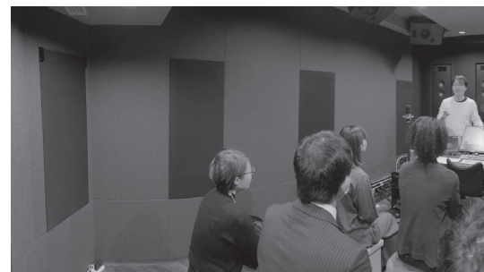
サイド側スピーカー配置（前方から 50° 100° 135° 155° リアスピーカー下には下層となるスピーカーが設置
